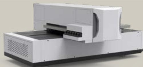
La stampante flatbed UVLed NV69x, configurabile con teste di stampa Epson i1600 o Epson i3200, rappresenta un'ottima scelta per la stampa di qualità ad alta velocità. Il piano di stampa ha dimensione 90 x 60 cm ed è dotato di un'aspirazione automatica che offre la possibilità di stampare su diversi supporti senza utilizzare nastri di fissaggio.
