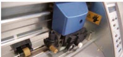
I motori servocontrollati installati su GX-PRO consentono un trascinamento perfetto, un movimento del carrello ottimale e soprattutto, il taglio di linee curve e cerchi in maniera perfetta e senza scalettature. Sul modello GX-640 sono installati motori servocontrollati ad alta capacità di carico. Infatti, essendo
