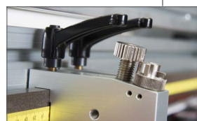
Vite di registro pressione della lama da utilizzare a seconda del tipo di materiale da tagliare
